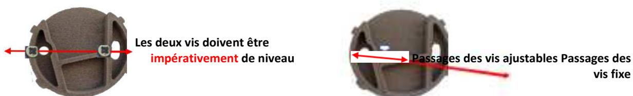
**b:** Fixer l'ensemble formé du couvercle, du marbre et du bouton-poussoir sur le socle, en effectuant un mouvement circulaire appelé 1/4 de tour, dans le sens des aiguilles d'une montre, d'environ 45°; un clic se fera entendre lorsque vous aurez dépassé le cran de fixation et de sécurité du bouton.
